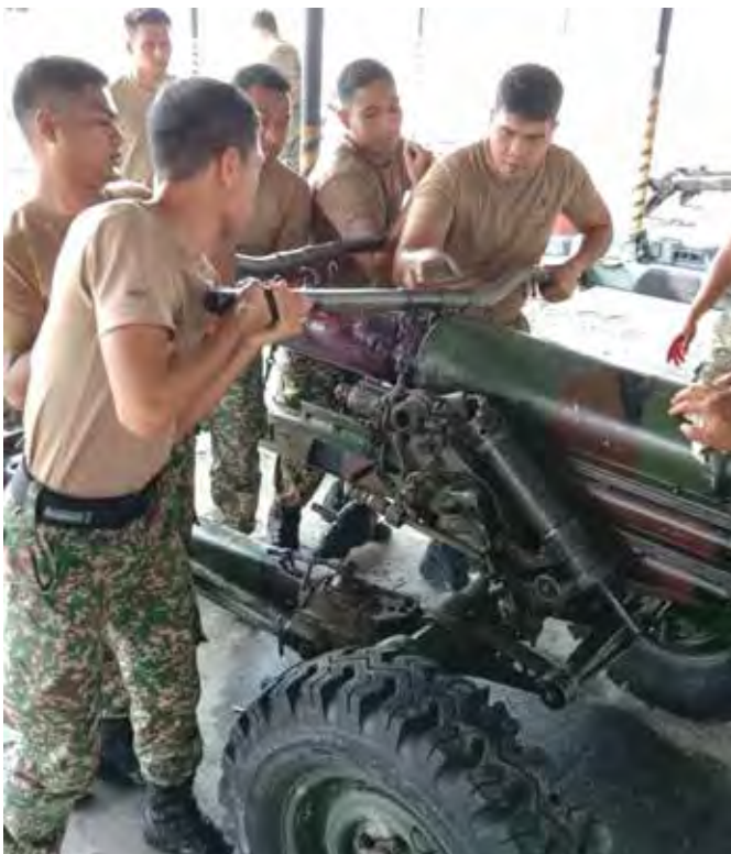
Semasa pemasangan semula komponen meriam 105mm L5 PH.
