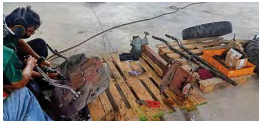
Kerja-kerja pembaikan meriam 105mm PH L5 Oto Melara.
