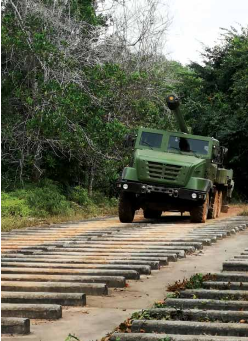
Ujian halangan bagi Sistem Suspensi CAESAR® di atas speed hump.
