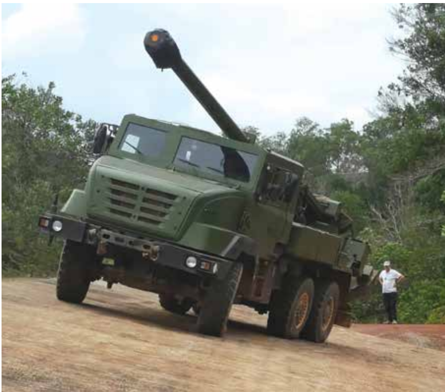
Slide Slope Test bagi menguji kestabilan CAESAR® di atas jalan berbukit.
