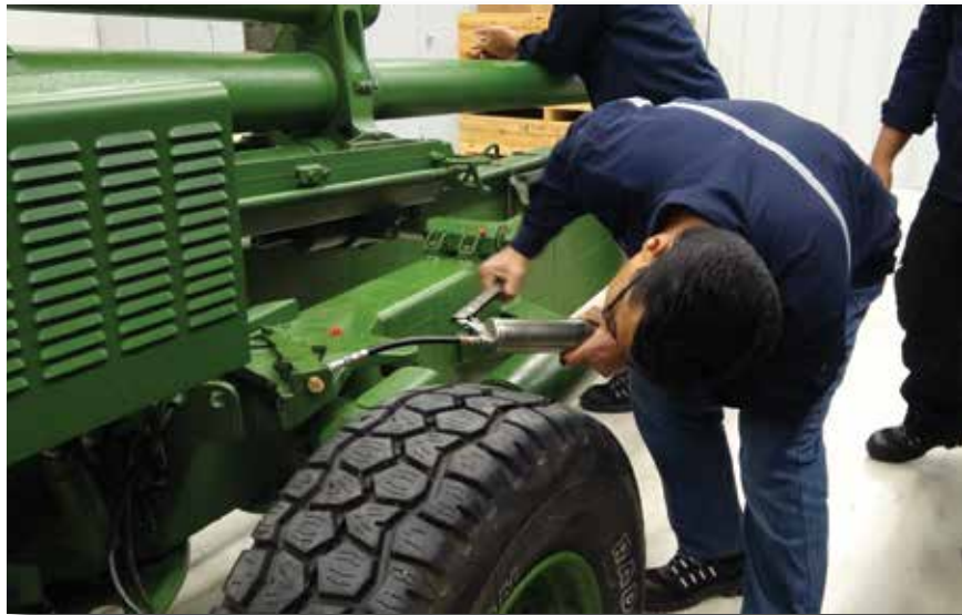
Memasukkan minyak gris pada semua nipple meriam.
