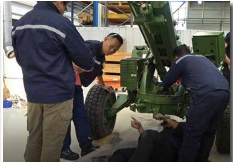
Membuka dan memasang platform meriam.
