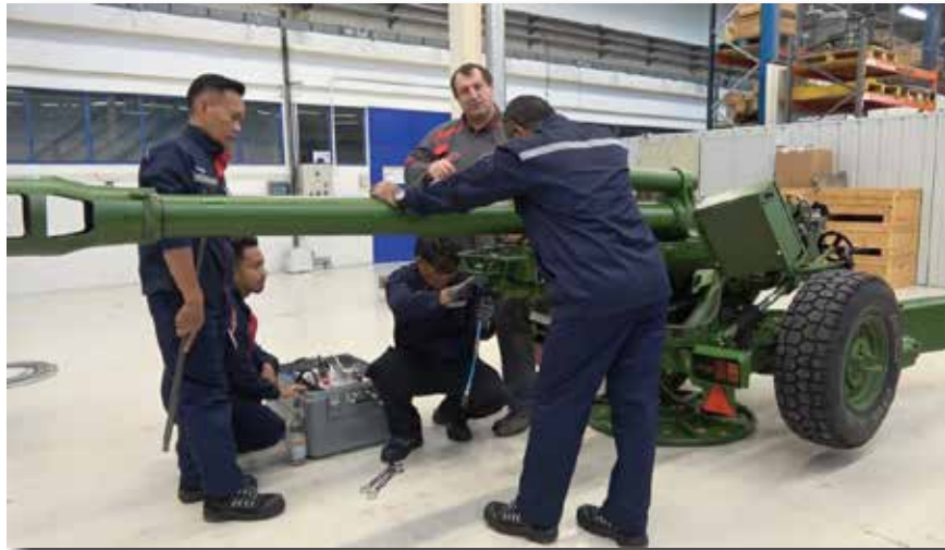
Memeriksa kuantiti minyak pada recoiling system
