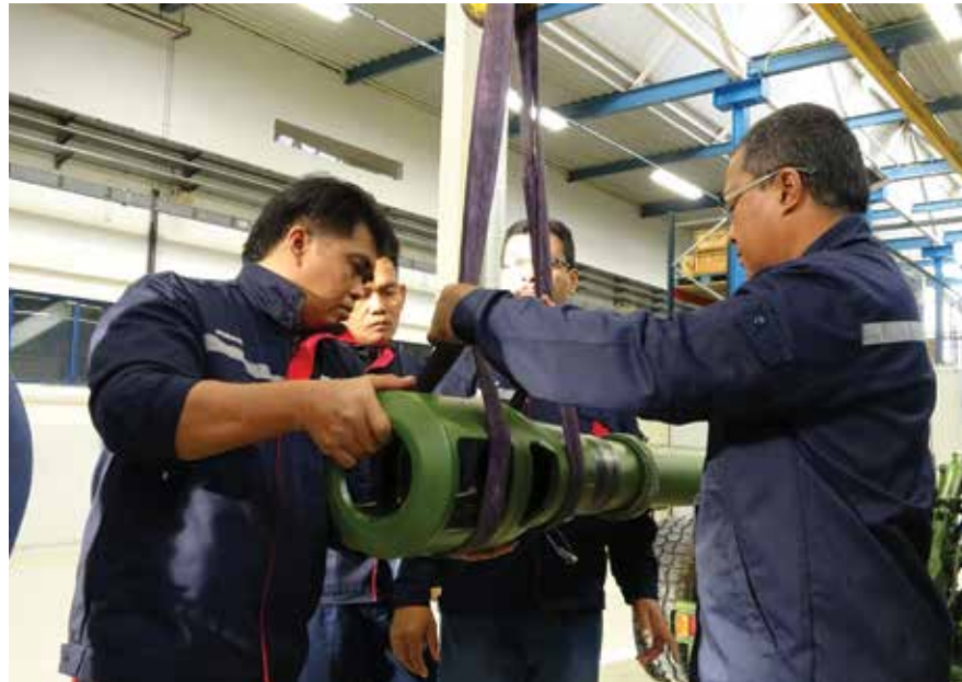
Membuka dan memasang semula muzzle brake.
