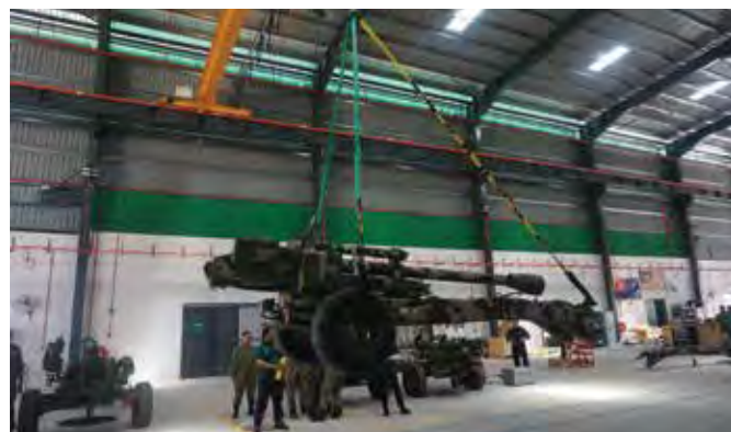
105mm LG1 MKIII diangkat dengan 5 Tonne Overhead Crane.
